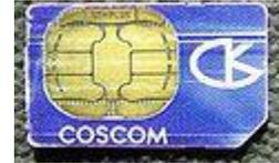
Le prime SIM realizzate misuravano 15×25 mm e hanno un angolo smussato per capire la giusta posizione di inserimento e inizialmente contenevano 0,5, 1 e 2 kilobyte (KB = 10<sup>3</sup> byte) di memoria. Quelle risalenti al 1998/1999 sono da 8 KB (dotate di 120 posizioni in rubrica e 10 sms memorizzabili). Successivamente sono comparse quelle da 16KB, 32KB, 64KB, 128KB e 256KB.
